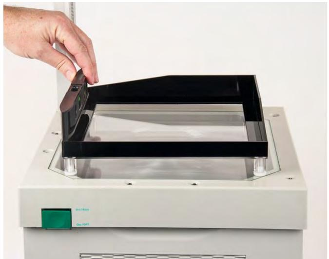
3. Ist die Wanne nicht waagrecht, kann durch Drehen der Kunststoffschrauben an den Füßen die Wanne rasch in die richtige Position gebracht werden.
