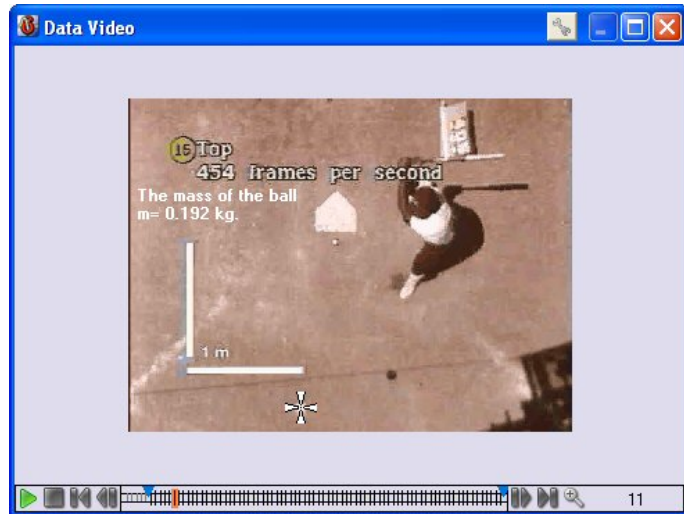
Abbildung 18. Bei der manuellen Videovermessung wird ein Sucher als Mauscursor verwendet, um das bewegende Objekt zu orten.
